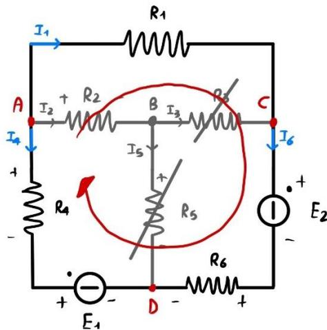
$$-R_4 I_4 + R_1 I_1 + E_2 + R_6 I_6 - E_1 = 0$$
