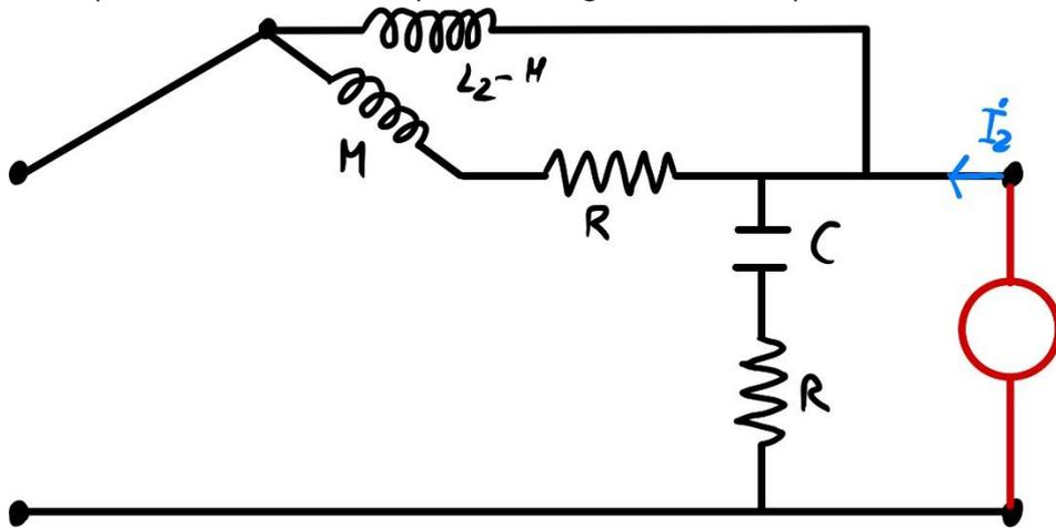
I rami con gli induttori spariscono perchè non sono percorsi da corrente (siamo vicini ad un aperto)! Anche qua circuito semplice: non fa molta differenza mettere un generatore o un altro. Mettiamolo di corrente!
