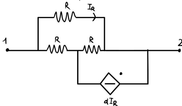
Abbiamo un generatore pilotato, che ci impedisce di concludere subito col calcolo della resistenza vista. Introduciamo un generatore di tensione indipendente  $V_p$  a capo dei morsetti 1 e 2: dobbiamo trovare  $I_p$
