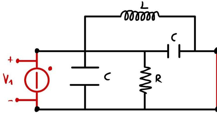
Abbiamo scelto un generatore di tensione, che ci permette un'applicazione istantanea di tensioni di nodo: non abbiamo da scrivere equazioni!
