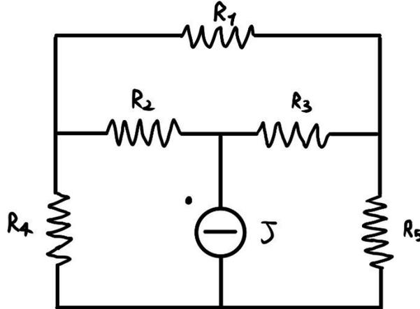
Le incognite sono le tensioni di nodo, cioè le tensioni ai capi di tutti i rami del circuito. Duale del metodo precedente, anche qua sensazione di parlare di qualcosa di improprio. Abbiamo  $n$  incognite (il numero di nodi).
