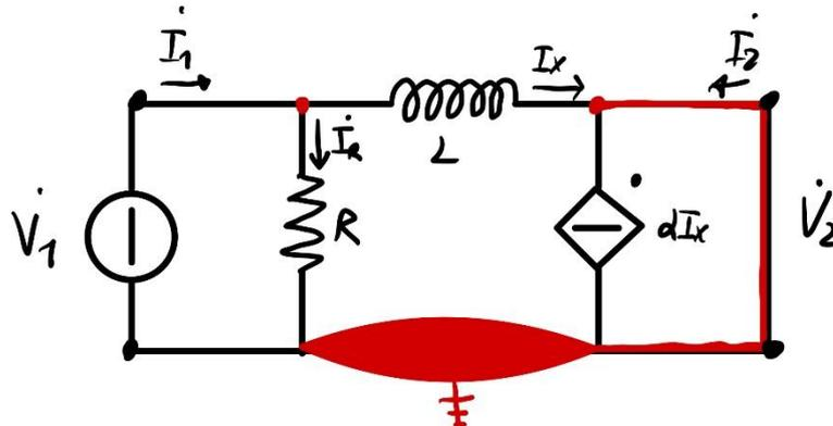
$$1^\circ \text{K al nodo sopra la resistenza: } \dot{I}_1 = \dot{I}_R + \dot{I}_x = \frac{\dot{V}_1}{R} + \frac{\dot{V}_1}{j\omega L} = \left( \frac{1}{R} + \frac{1}{j\omega L} \right) \dot{V}_1$$
