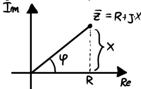
Otteniamo  $R = Z \cos \phi$  e  $X = Z \sin \phi$ . Segue (le nuove espressioni sono utili quando non si conosce  $\phi$  o  $V$ )
