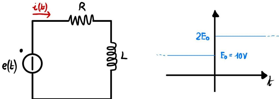
Se consideriamo solo tempi negativi o solo tempi positivi otteniamo un circuito in continua, dove l'induttore viene sostituito con un cortocircuito (si pongono in verde le correnti che circolano nel circuito).
