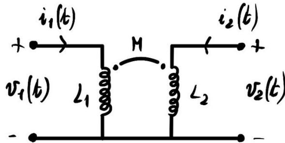
Essi hanno un nodo in comune (una caratteristica fondamentale): è possibile introdurre un'alterazione topologica dove rappresentiamo due induttori mutuamente accoppiati con tre induttori indipendenti.
