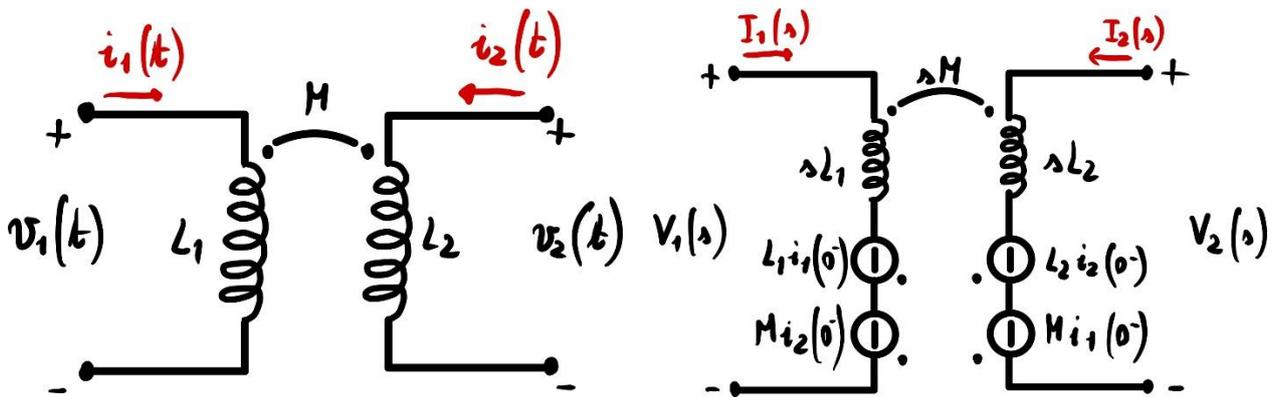
$$\begin{cases} v_1(t) = L_1 \frac{di_1(t)}{dt} \pm M \frac{di_2(t)}{dt} \\ v_2(t) = L_2 \frac{di_2(t)}{dt} \pm M \frac{di_1(t)}{dt} \end{cases} \Rightarrow \begin{cases} V_1(s) = L_1 \mathcal{L} \left\{ \frac{di_1(t)}{dt} \right\} \pm M \mathcal{L} \left\{ \frac{di_2(t)}{dt} \right\} \\ V_2(s) = L_2 \mathcal{L} \left\{ \frac{di_2(t)}{dt} \right\} \pm M \mathcal{L} \left\{ \frac{di_1(t)}{dt} \right\} \end{cases}$$
