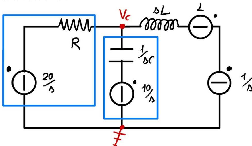
Applichiamo tensioni di nodo, risolviamo con un'unica equazione! Si osservi la presenza di ben due generatori di tensione reali (quelli evidenziati), che sostituiamo con gli equivalenti Norton.
