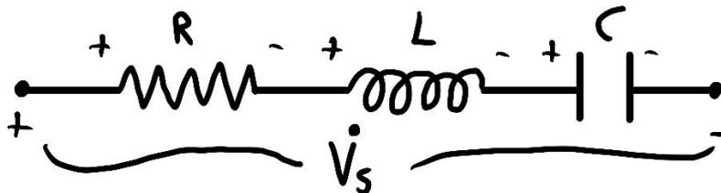
Nel dominio del tempo abbiamo visto in modo approfondito come ricondurre resistenze in serie e/o in parallelo a un'unica resistenza equivalente agli effetti esterni. Sempre nel dominio del tempo non è possibile ricondurre i tre bipoli in figura a un unico bipolo elettrico: le cose cambiano nel dominio dei fasori! Vogliamo trovare la tensione ai capi dei morsetti + e -
