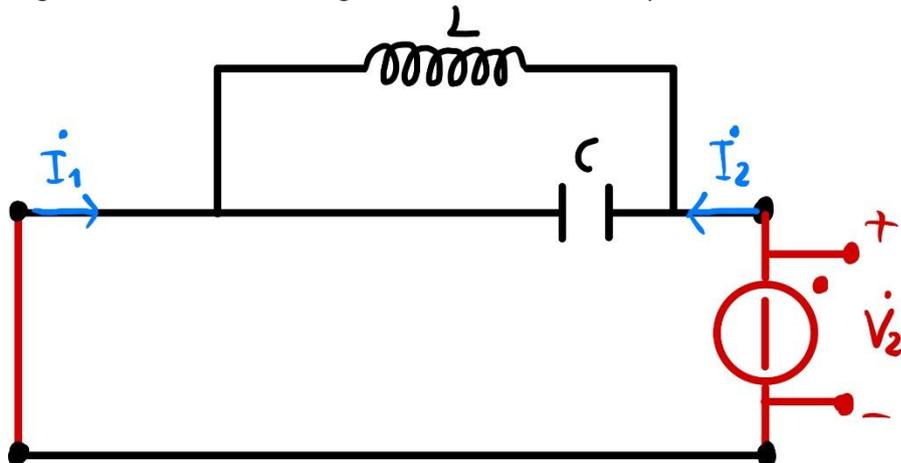
Poniamo un generatore di tensione. Condensatore e induttore sono posti in parallelo: li possiamo trattare come un'unica impedenza avente il seguente valore
