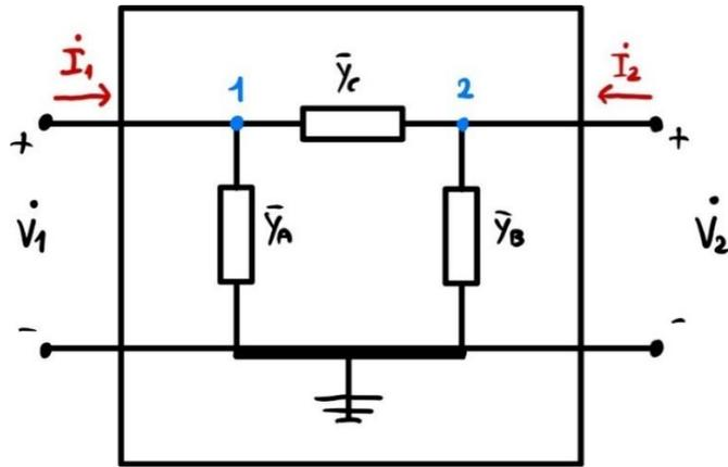
Risolviamo il metodo con le tensioni di nodo: scegliamo come nodo di riferimento quello indicato in figura e lavoriamo sui nodi 1 e 2 evidenziati in figura.
