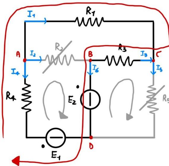
$$-R_4 I_4 + R_1 I_1 - R_3 I_3 + E_2 - E_1 = 0$$
