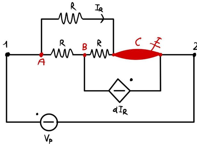
Applichiamo il metodo delle tensioni di nodo: tutte e tre le tensioni di nodo risultano già definite senza passare dalle equazioni previste dal metodo.
