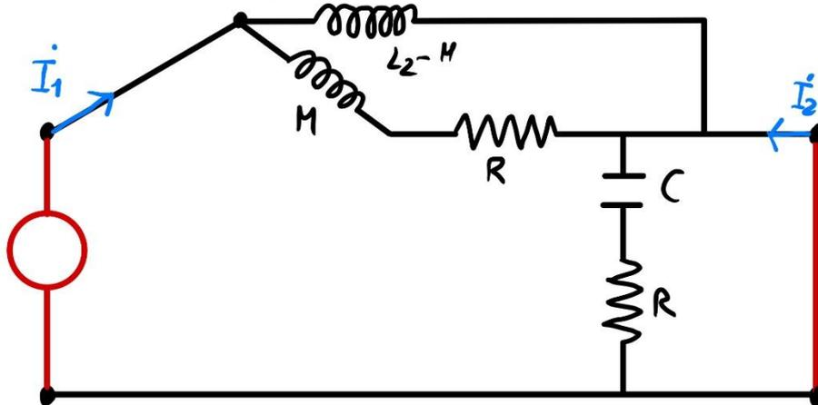
La prima cosa che notiamo è il ramo con condensatore e resistenza è in parallelo a un cortocircuito: quindi sparisce.
