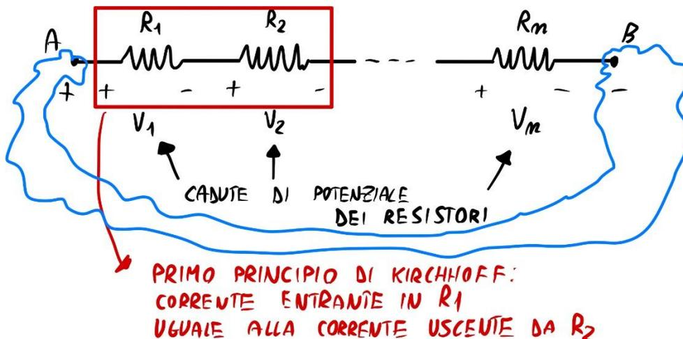
La cosa ci torna perché applicando il principio di Kirchoff otteniamo che la corrente entrante è uguale alla corrente uscente. Quello che vogliamo fare è calcolare la resistenza equivalente agli effetti esterni  $R_{eq}$ , in un certo senso è come sostituire gli  $n$  resistori con un'unica resistenza collegata a un circuito esterno (che non conosciamo)
