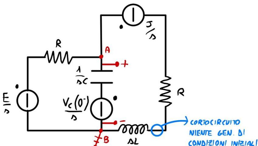
Occhio a quale tensione del condensatore calcoliamo: il condensatore, nel dominio di Laplace, è un condensatore in serie a un generatore di condizioni iniziali (non va bene calcolare la tensione
