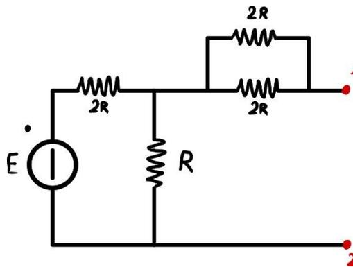
Semplifichiamo le due resistenze  $2R$  disposte in parallelo e teniamo presente sul ramo vicino ad 1 non scorre più corrente (dato che abbiamo scollegato la sottorete dal resto del circuito, la cosa è dimostrabile applicando il primo principio di Kirchoff rispetto alla linea chiusa rossa in figura).
