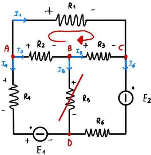
$$-E_1 - R_4 I_4 + R_2 I_2 + R_5 I_5 = 0$$
