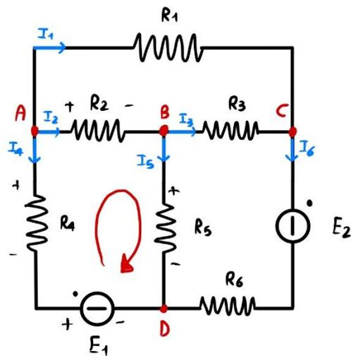
$$-R_2 I_2 + R_1 I_1 - R_3 I_3 = 0$$
