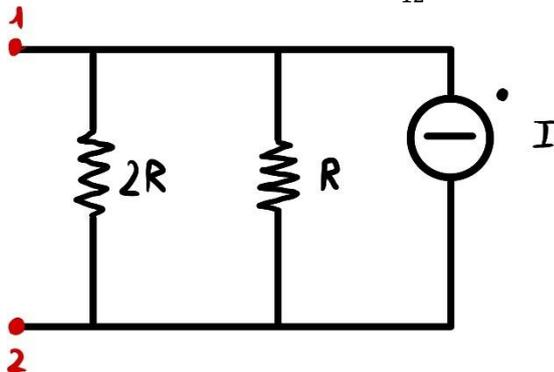
Vari metodi per calcolare la tensione: in generale si sceglie un percorso da 1 a 2 e si sommano tutte le cadute di potenziale lungo questo percorso. Si osservi che non ha senso scegliere un percorso passante da un generatore di corrente, in quanto la tensione ai capi del generatore è indeterminata. Il percorso scelto è quello indicato con la freccia
