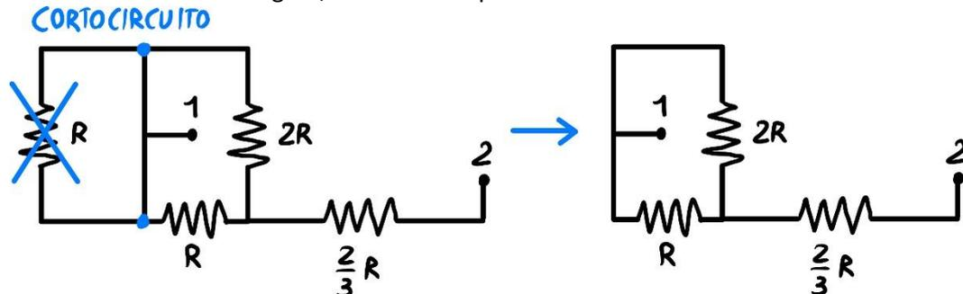
Se una resistenza è in parallelo a un cortocircuito allora tutta la corrente scorre nel cortocircuito. È come avere sul ramo del cortocircuito un resistore con resistenza nulla!
