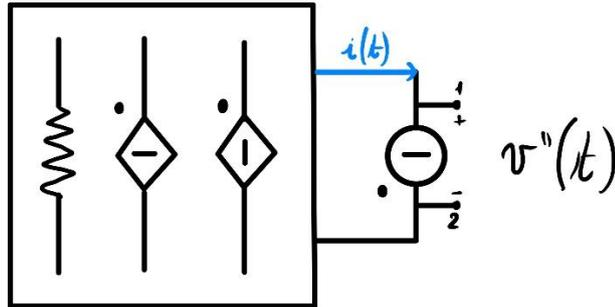
Se non sono presenti generatori di alcun tipo nel box allora possiamo sostituire la sottorete con un'unica resistenza vista
