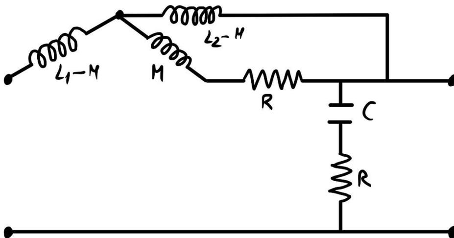
L'induttore  $L_1 - M$  diventa un cortocircuito, dato che  $L_1 - M = 10 \text{ mH} - 10 \text{ mH} = 0$ .
