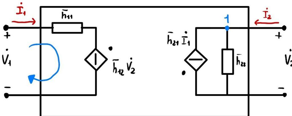
Con l'applicazione del secondo principio di Kirkhoff sulla parte sinistra del circuito (maglia indicata in figura, la unica possibile) e del primo principio di Kirkhoff sulla parte destra del circuito (nodo evidenziato in figura) otteniamo le equazioni viste prima
