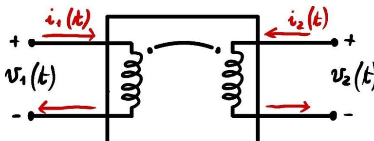
I valori di nostro interesse sono: le correnti  $i_1(t), i_2(t)$ ; le tensioni  $v_1(t), v_2(t)$ . Nella teoria dei circuiti a due porte rientrano tutti i componenti elettrici che elaborano un segnale di ingresso alla porta 1 per trasformarlo in un segnale di uscita passante dalla porta 2. Detta in notazione matematica:
