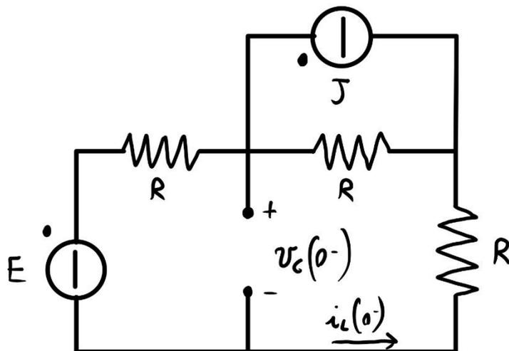
Due strade: applicare il principio di sovrapposizione degli effetti, applicare un metodo generale per la risoluzione di un circuito. Appliciamo correnti di maglia
