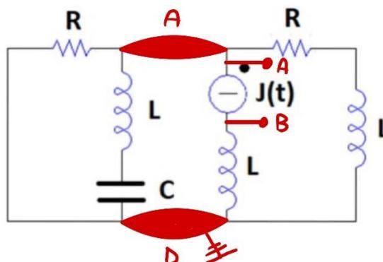
Si ricordi che la tensione ai capi del generatore è diversa dalla tensione ai capi del ramo (in questo ramo sono presenti, in serie, un generatore di corrente e un induttore): vogliamo  $\dot{V}_{AB}$ , non  $\dot{V}_{AD}$ .
