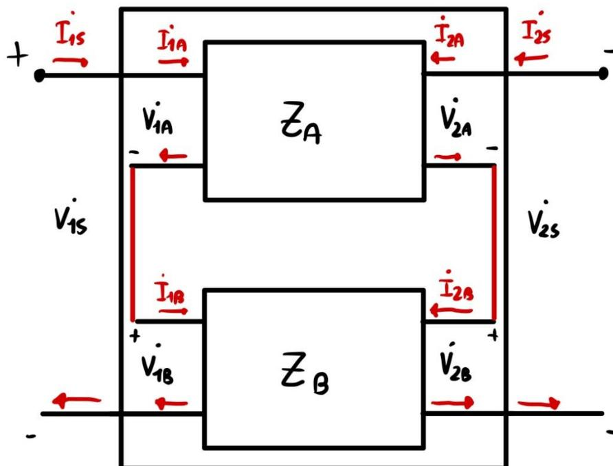
Quali sono i parametri z? Consideriamo che le cadute di potenziale del circuito a due porte unico si ottengono dalla sommatoria di due cadute di potenziale (secondo principio di Kirchoff).
