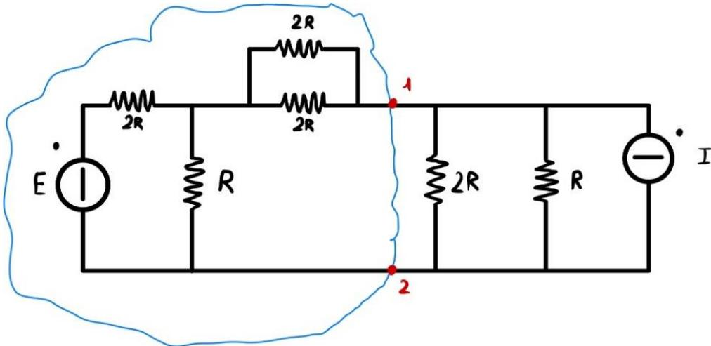
Potrebbe essere utile trovare una sottorete equivalente agli effetti esterni, rispetto alla sottorete evidenziata in figura. Non bastano le nozioni viste fino ad ora (nella sottorete è presente un generatore).
