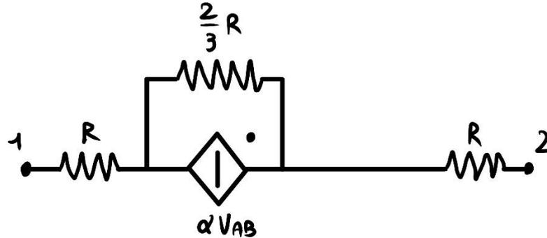
Attenzione al generatore pilotato, che ci impedisce di poter concludere al volo calcolando la resistenza vista. Necessario introdurre un generatore indipendente ai capi dei due morsetti.
