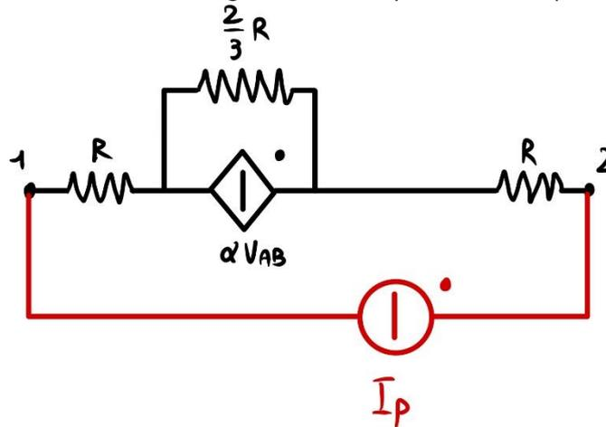
Poniamo un generatore di corrente, questo significa che dovremo trovare  $V_p$  e sostituire nella seguente formula
