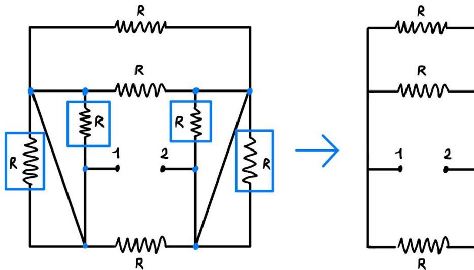
Possiamo concludere perché le tre resistenze rimanenti sono disposte in parallelo. Dato che le resistenze hanno stesso valore possiamo concludere senza fare calcoli che  $R_{eq} = \frac{R}{3}$
