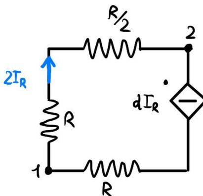
È presente un generatore pilotato di corrente, ergo non possiamo concludere al volo trovando la resistenza vista. Introduciamo un generatore indipendente di corrente. Si osservi che entrambe le maglie presentano un generatore di corrente (chiameremo le correnti di maglia con i nomi delle correnti erogate dai generatori).
