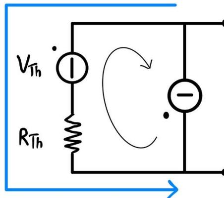
Affinchè si abbia equivalenza è necessario che la tensione  $v(t)$  ai morsetti sia la stessa di prima. Scegliamo anche qua un percorso che non passi da generatori di corrente e applichiamo il 2° principio di Kirkhoff
