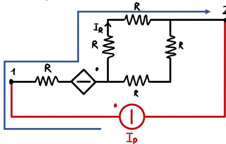
Un generatore di tensione, che ci porterebbe all'applicazione di tensioni di nodo, non è assolutamente conveniente: l'aggiunta del generatore di tensione di prova non ci permette di ridurre il numero di equazioni da sviluppare. Segue che poniamo un generatore di corrente  $I_p$ , e che dobbiamo calcolare  $V_p$
