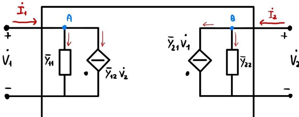
Applicando il primo principio di Kirchoff sui nodi A e B evidenziati in figura otteniamo le equazioni del sistema
