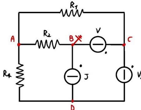
Quanto vale la tensione di nodo in D? Si applica il secondo principio di Kirkhoff:
