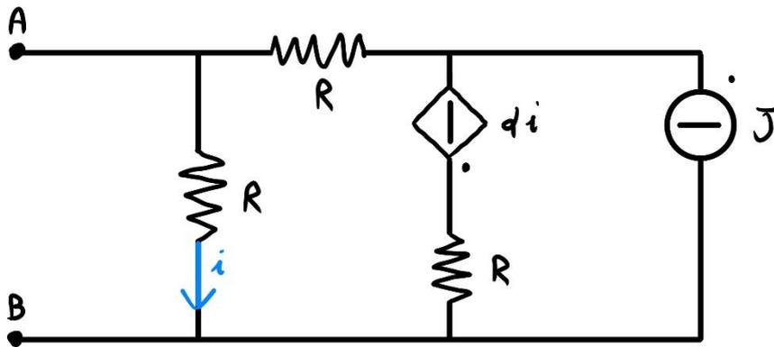
In presenza di generatori pilotati si aggiunge ai capi di A e B un generatore indipendente: nostra scelta se mettere un generatore di tensione o un generatore di corrente. Calcoliamo la resistenza come la tensione tra A e B divisa la corrente.
