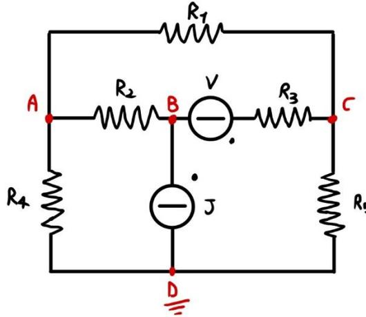
Si trasforma il generatore reale nel suo equivalente Norton!
