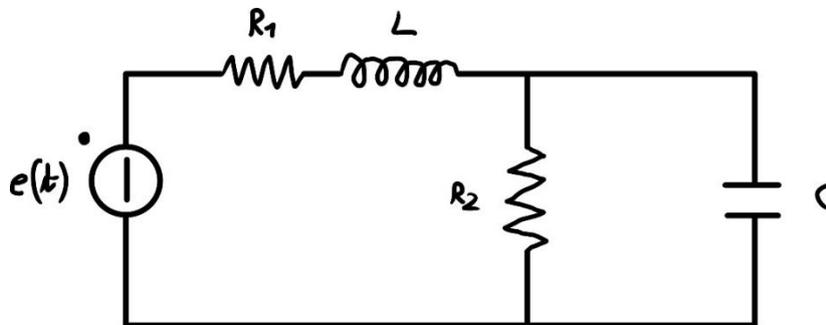
Supponiamo di avere una corrente erogata con andamento periodico e sinusoidale. Trasformiamo la formula in un fasore
