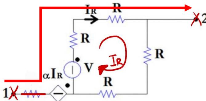
$$V_{Th} = V_{12} = -\alpha I_R - V + RI_R + RI_R$$
