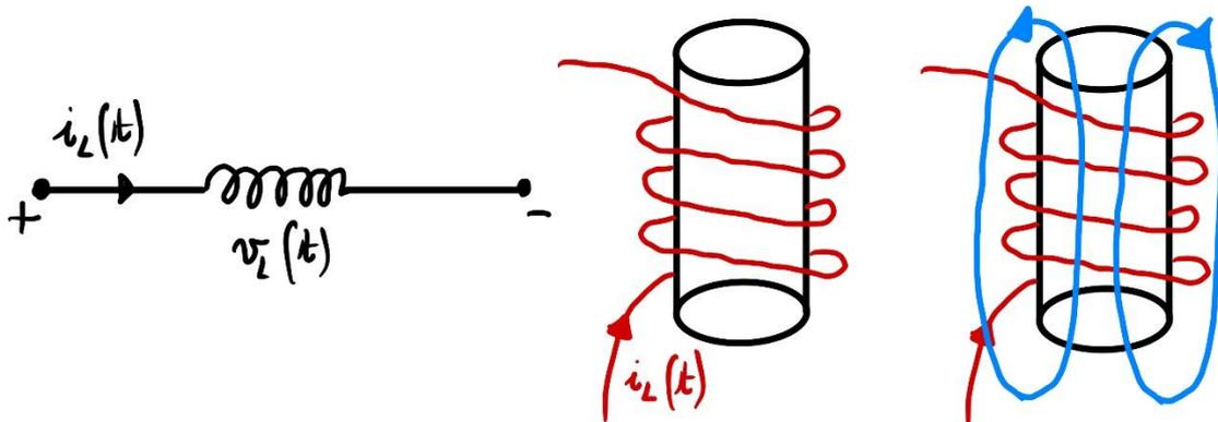
Il campo magnetico generato è direttamente proporzionale alla corrente. Si ricordi che le linee del campo magnetico sono linee chiuse, e che il verso è dato dalla regola della mano destra (pollice segue il verso della corrente, il palmo guarda il verso delle linee di campo magnetico verso l'alto).
