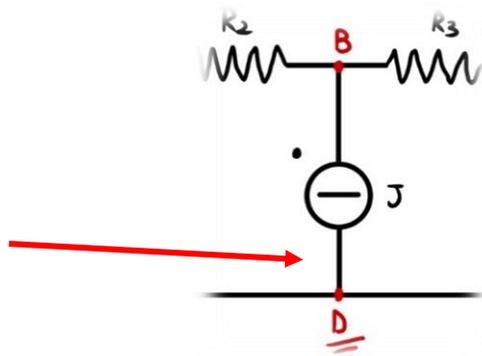
Non cambia niente, resistenze disposte in serie a generatori di corrente non hanno alcuna influenza nella scrittura delle equazioni col metodo delle tensioni di nodo (la corrente che passa per quel ramo è quella erogata dal generatore, punto).
