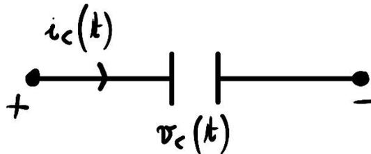
La carica sulle armature è direttamente proporzionale alla differenza di potenziale ai capi del condensatore.
