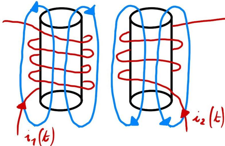
Le linee del campo magnetico  $B_2$ , generato dalla corrente  $i_2$ , si richiudono sul primo induttore. Detta in altre parole: le linee di campo magnetico completamente concatenate sul primo induttore non sono solo quelle causate dalla corrente  $i_1$ , ma anche linee di campo causate dalla corrente  $i_2$ .
