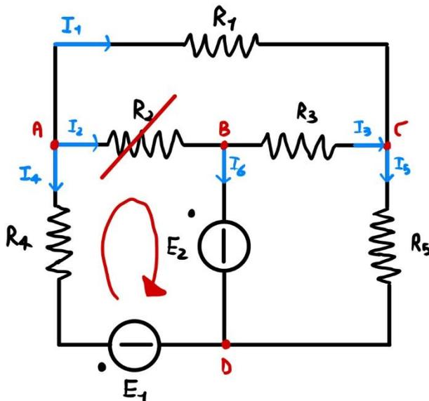
$$-R_1 I_4 + R_2 I_2 + E_2 - E_1 = 0$$
