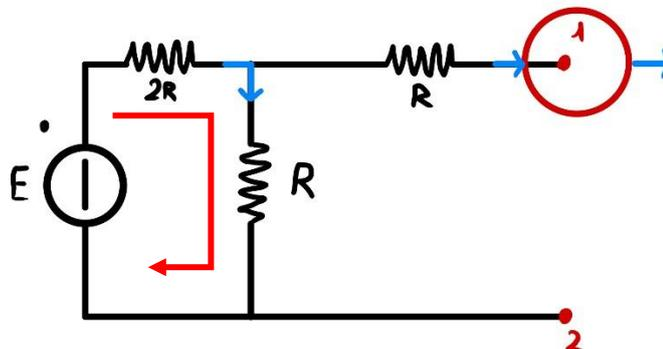
Segue che possiamo trattare le due resistenze rimanenti come due resistenze disposte in serie e applicare il partitore di tensione per trovare  $V_{12}$ .
