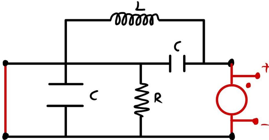
Si osservi che abbiamo ben due rami paralleli al cortocircuito (quello immediatamente vicino col condensatore e anche quello con la resistenza). Otteniamo un circuito estremamente semplice dove scegliere generatore di tensione o generatore di corrente fa poca differenza.
