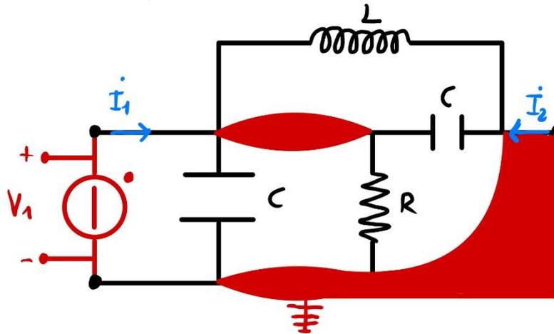
Il nodo di riferimento ha tensione nulla, l'altro nodo avrà tensione  $V_1$ . Le correnti  $I_1$  e  $I_2$  non scorrono su particolari impedenze. Definiamo ulteriori correnti, applichiamo il primo principio di Kirkhoff sull'area evidenziata e sviluppiamo la formula
