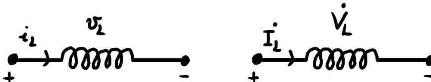
$$v_L(t) = L \cdot \frac{di_L(t)}{dt} \Rightarrow \dot{V}_L = j\omega L \cdot \dot{I}_L = j\omega L I_M \cdot e^{j\phi_I}$$
