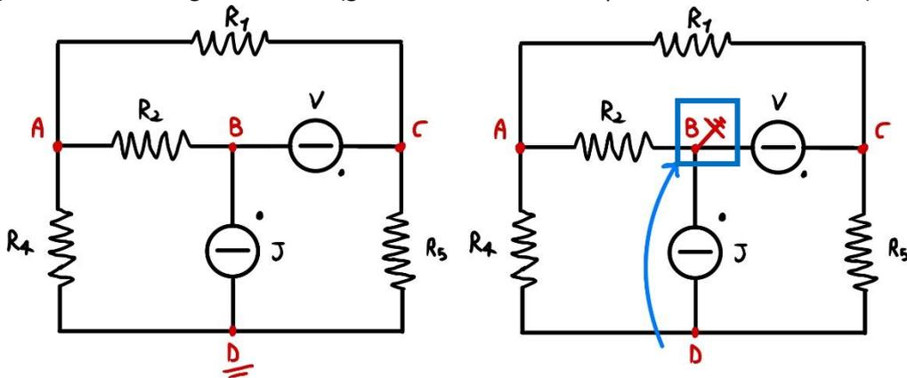
In questo circuito non è più conveniente mantenere il nodo D come nodo di riferimento. Si pone il nodo B come nodo di riferimento, in modo tale da poter dire  $V_B = 0$ ,  $V_C = V$
