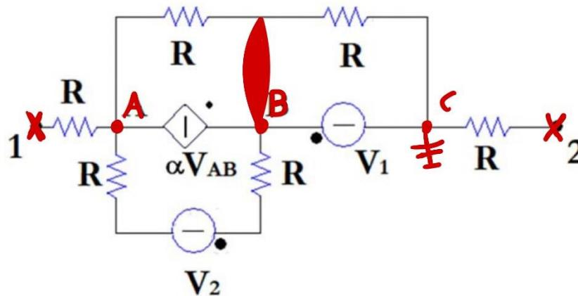
Poniamo il nodo C come nodo di riferimento. Si osservi che  $V_{Th} = V_A - V_C = V_A$ : segue che trovando  $V_A$  avremo trovato automaticamente  $V_{Th}$
