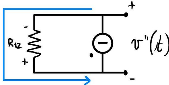
Scegliamo un percorso che non passi dal generatore di corrente, dove la tensione è indeterminata. Appliciamo il secondo principio di Kirkhoff sul percorso
