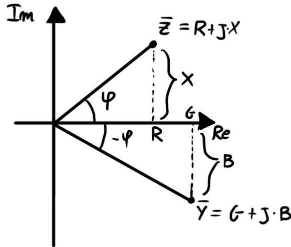
Otteniamo  $G = y \cos(-\phi) = y \cos(\phi)$  e  $B = y \sin(-\phi) = -y \sin(\phi)$ . Segue
