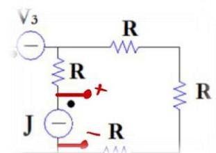
La corrente  $J$  è un valore noto, mentre la tensione  $V_j$  non lo è. Quest'ultima è indeterminata se consideriamo il generatore da solo: può essere calcolata solo se si considera il resto del circuito. Occhio fin da subito alla presenza di un generatore di tensione reale (che trattiamo nel punto successivo).
