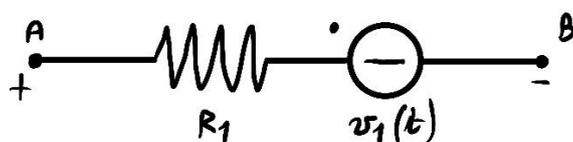
La tensione ai capi di A e B è ovviamente più piccola di  $v_1(t)$ . A questo punto disponiamo in parallelo due pile reali e applichiamo il secondo principio di Kirkhoff.
