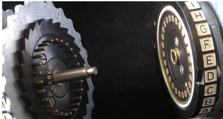
Ogni rotore rappresenta la permutazione di un alfabeto. Possiede due facce : *pad* e *pin*, ciascuna con ventisei contatti elettrici disposti in cerchio e ciascuno associato a una particolare lettera. Si ha un cablaggio fisso che collega i contatti di una faccia con quelli di un'altra.
